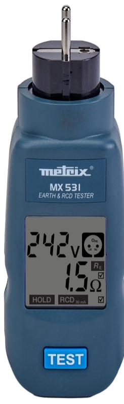
Contrôleur de terre &amp; testeur RCD 30 mA
